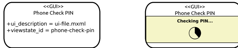
Abbildung 3: Unterschiedliche Darstellung von Zuständen mit dem STEREOTYP <<GUI>>. Links: Anzeige der Attribute und ihrer Werte in textueller Form innerhalb des Zustands; Rechts: Darstellung des referenzierten Widgets im Zustand.
